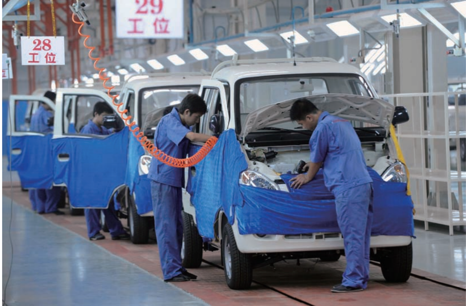
大型純電気自動車生産基地である天津清源電気自動車開発・産業化基地で、小型電気トラックを組み立てている従業員（劉海峰撮影）
